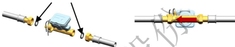
③如图所示再使用扳手拧紧螺母， $120^{\circ}$ - $180^{\circ}$ （扭力  $10$ - $25\text{Nm}$ ， $G3/4''$ ）， $90^{\circ}$ - $120^{\circ}$ （扭力  $20$ - $50\text{Nm}$ ， $G1''$ ）注意：过度拧紧会损坏热表。
